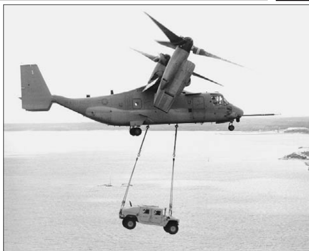
Самолет с укороченным взлетом и вертикальной посадкой MV-22 морской пехоты ВМС США
